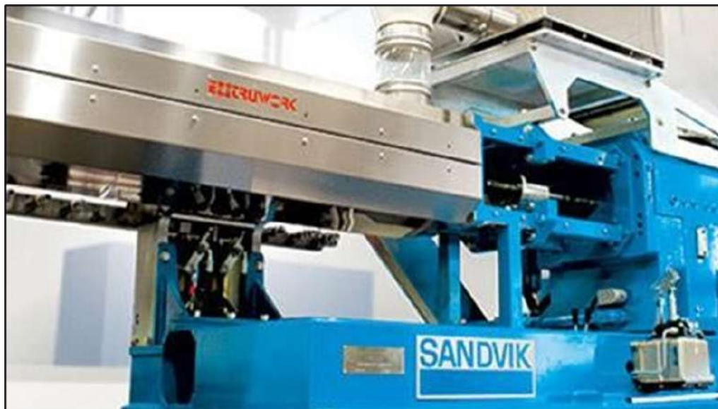
Фото 2.1 - Установка грануляции по технологии «Ротоформ» компании «Сандвик»
