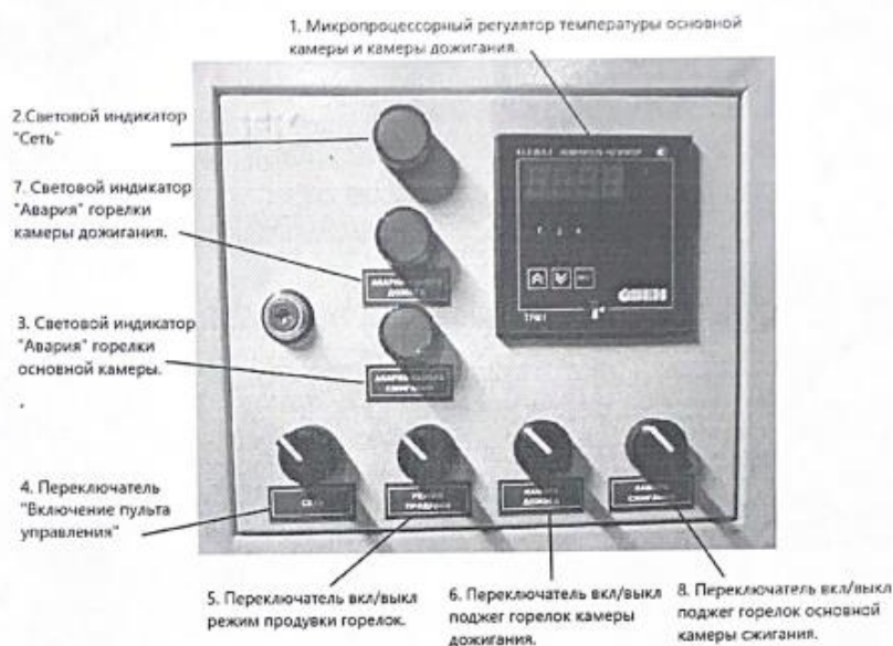
Рисунок 4.2 – Пример панели управления инсинератором (Тип 2) мульти горелочный.
