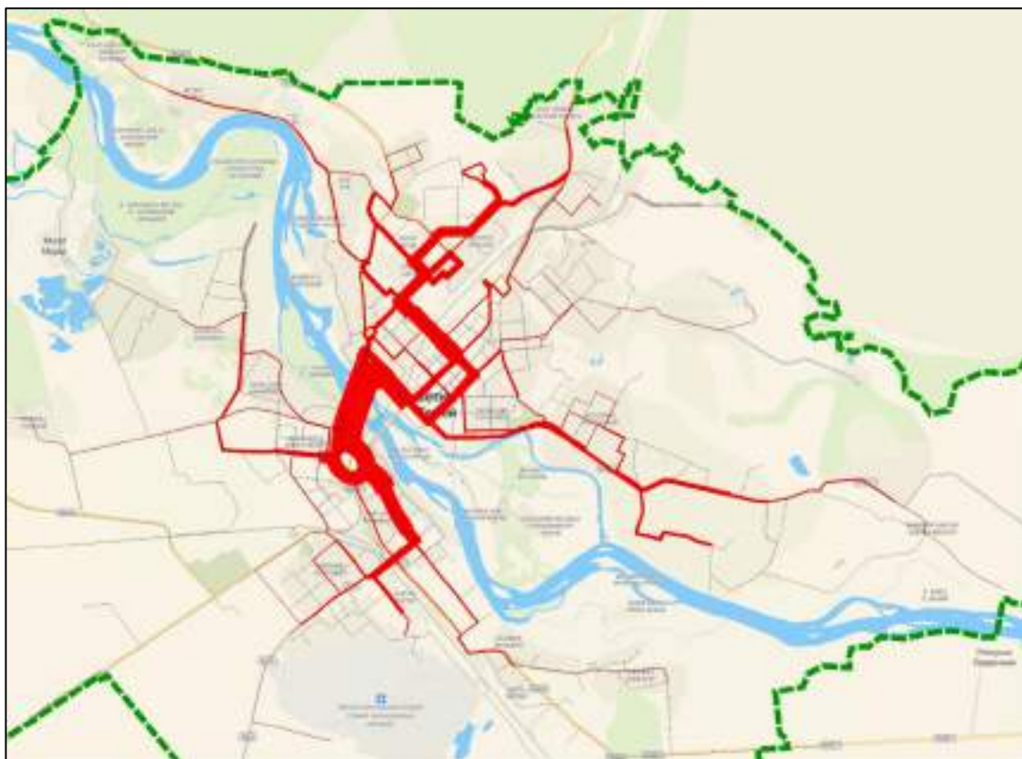
8.3-сурет. Семей қаласының жолаушылар көлігі желісіндегі таңғы «қарбалас» сағаттағы жолаушылар ағындарының картограммасы, 2026 жыл
