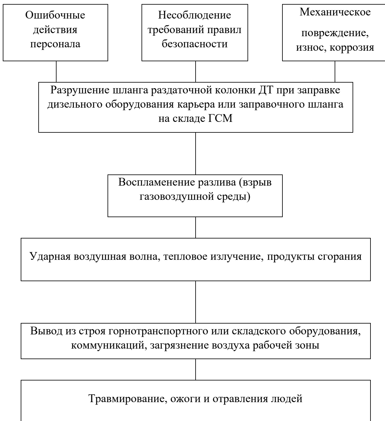
Рис.11.3 - Блок-схема вероятного сценария возникновения и развития аварии при заправке дизельного технологического оборудования карьера из топливозаправщика или заправке емкости на складе ГСМ
