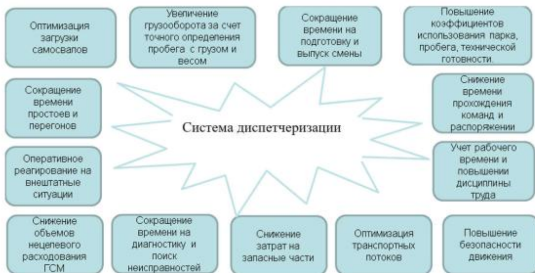
Рис. 8.1. Структура и функции системы диспетчеризации
